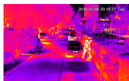
Détection de franchissement de ligne (thermique)
